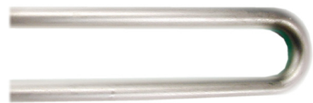
熱交換器內部銅管鍍鎳處理
